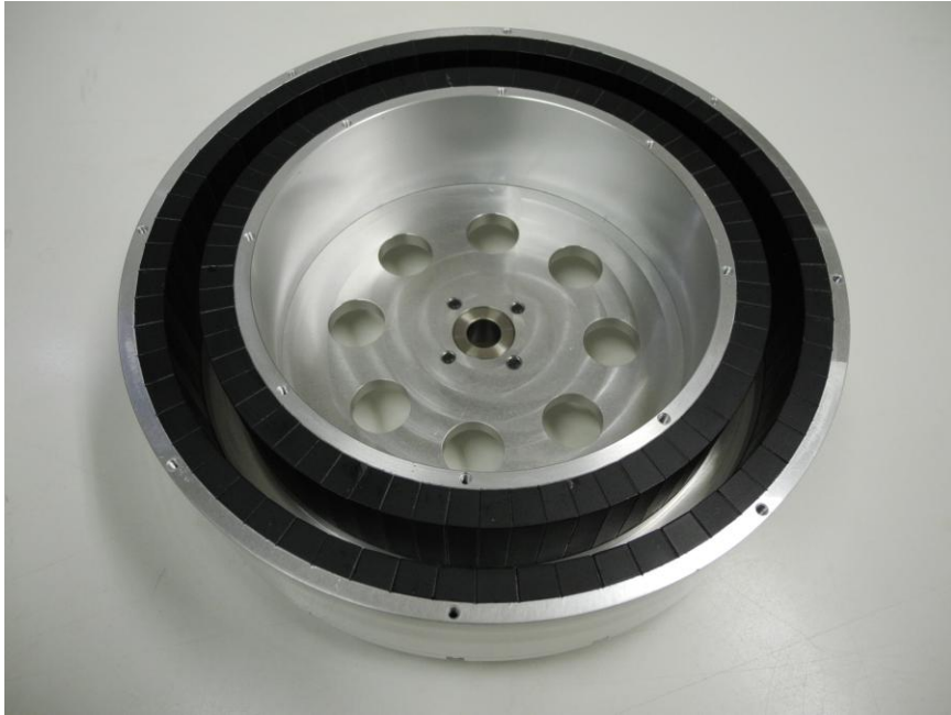
図5 磁石の配置と回転子の全体像
