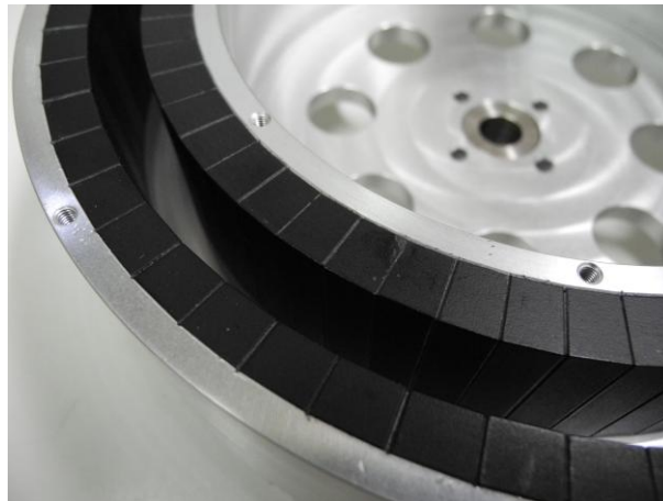
図6 回転子磁石の配置の実際（拡大図）
