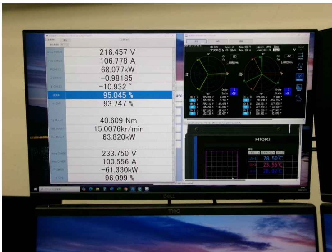
図⑤-6 c 測定データ（最大 100A、定格回転数 15,000rpm）の測定データ
