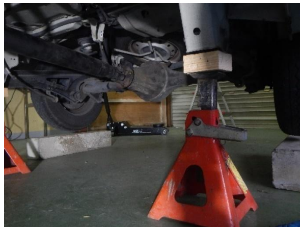
図 15-11 クランクシャフトとデフの接続
