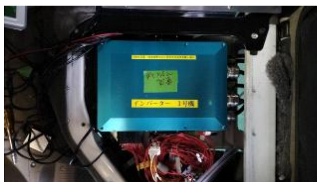
図 15-6 EV 車に取り付けたインバータ
