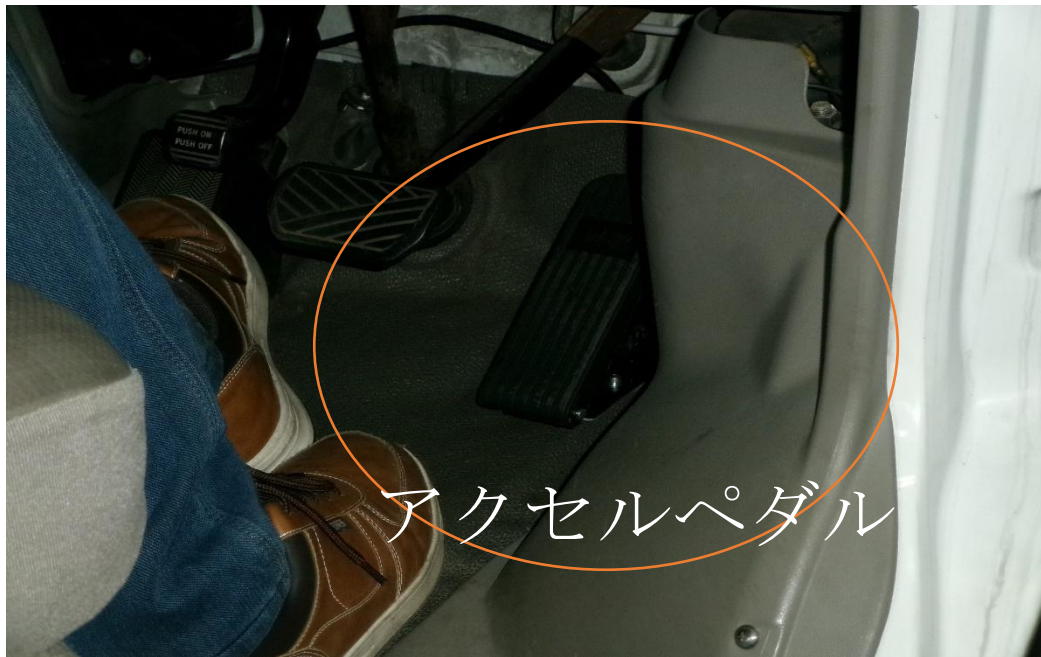
図 2-14 c アクセルペダルを EV 車に装着
