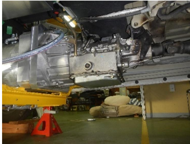
図 15-10 モーターと減速機接続
