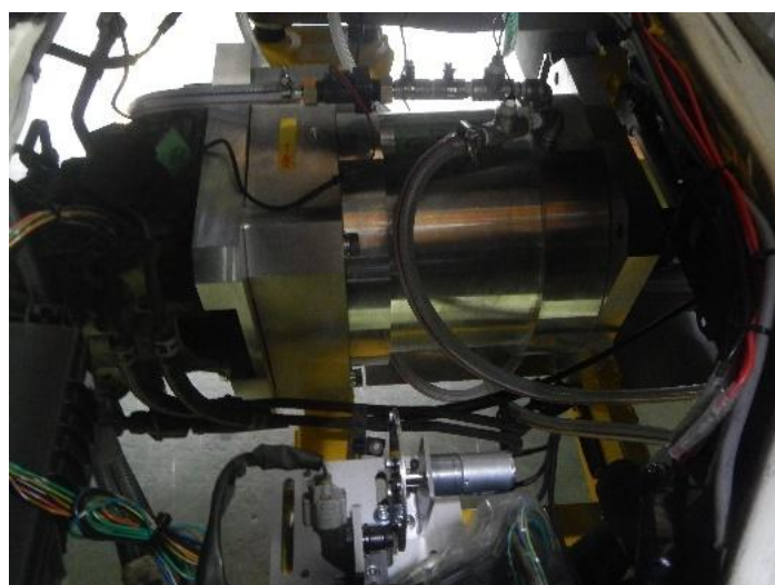
図 15-9 ハルバッハモータを改造 EV 車に取り付け
